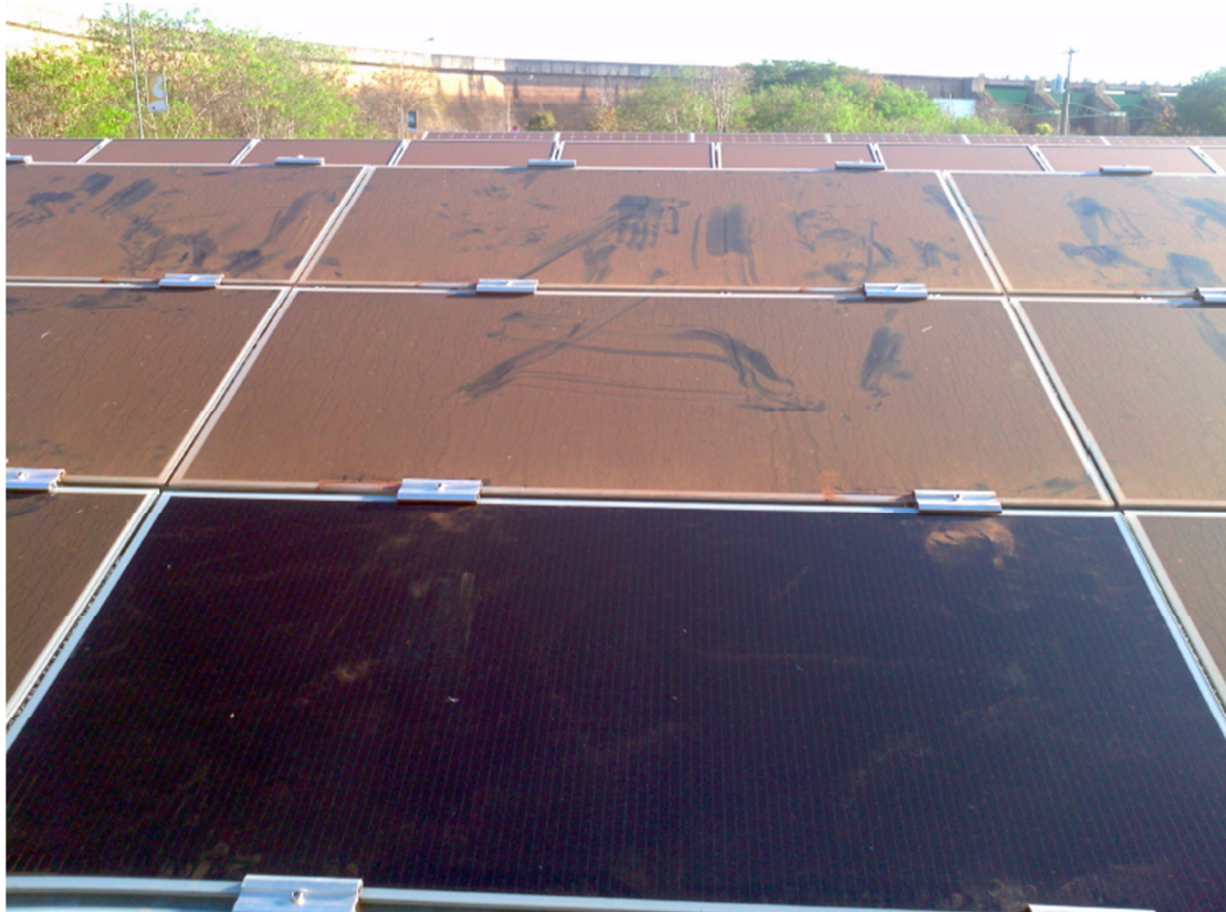
Figura 31: Exemplo de condições de soiling elevadas e uniformes em um local de teste de sistemas FV no sudeste brasileiro.
