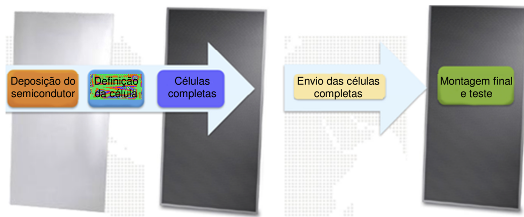
Figura 21: Fluxo conceitual e simplificado do processo de fabricação do módulo CdTe da First Solar, com divisão de linhas de produção ( Split Line ) do vidro ao módulo FV finalizado, no qual algumas das etapas iniciais do processo são realizadas na planta matriz (PBG ou KLM) e módulos de vidro simples com células completas são empacotados e enviados a outros lugares para a montagem final e teste em outra fábrica.
